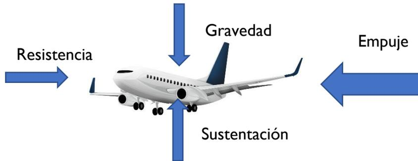
Si un avión vuela a una elevación constante, las fuerzas de sustentación y gravedad se cancelan entre sí. Por este motivo, se te pidió que recopilases datos por segunda vez cuando la altitud sea la misma que la del primer dato, cuando solo hay resistencia y empuje. Mientras el avión se desplaza hacia delante, la fuerza de empuje es mayor que la fuerza de resistencia. Por lo tanto, en los cálculos a continuación, la  $F$  representa el empuje.
