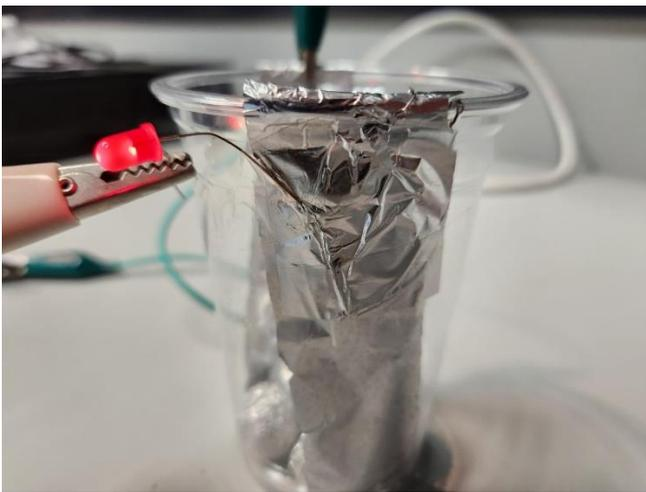
6. Conecte una pinza de cocodrilo al cable largo del LED. Conecte el otro extremo del cable al terminal POSITIVO de la batería.
